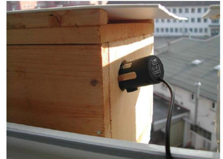
Die Technik: Einfache lichtstarke USB-Kameras mit Brennweite 5-20cm, ohne eigene Beleuchtung. Die notwendige Helligkeit kommt einzig durch das Flugloch
